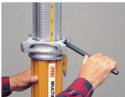
マルチプロップ調整リングはタイバーなどで回転させます
