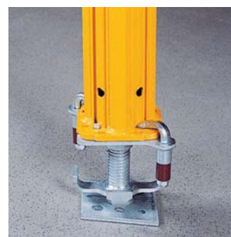
マルチプロップ 傾斜防止ベースMKF フレームと連結させ傾斜場面で使用 どの方向にも許容傾斜値は3°まで対応
