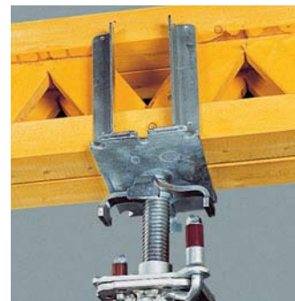
マルチプロップ傾斜防止フォークヘッド MKK PERIトラスビームGT24やVT24を固定 (シングル使用・ダブル使用、いずれも対応) どの方向にも許容傾斜値は3°まで対応
