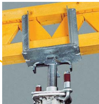
マルチプロップ傾斜防止フォークヘッド MKK PERIトラスビームGT24やVT24を固定 (シングル使用・ダブル使用、いずれも対応) どの方向にも許容傾斜値は3°まで対応
